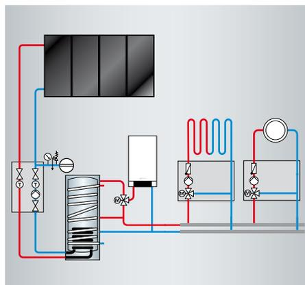
Solare Trinkwassererwärmung und Heizungsunterstützung
