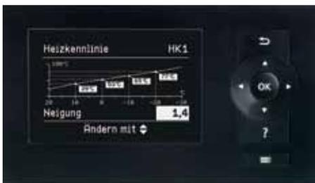
Vitotronic 200 Regelung – einfache Bedienung dank menügeführter Benutzerführung und grafischer Darstellung, wie z. B. der Heizkennlinienanzeige
